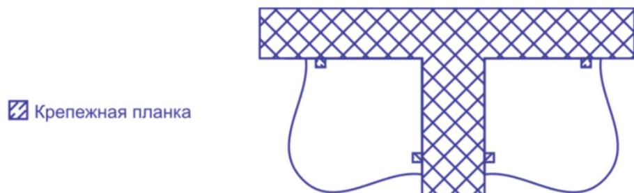
Рисунок 5.2.1. Схема рекомендуемых мест крепления к стене ванн разных конфигураций
