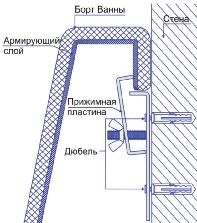
Рисунок 5.2.3. Схема монтажа ванны к стене
