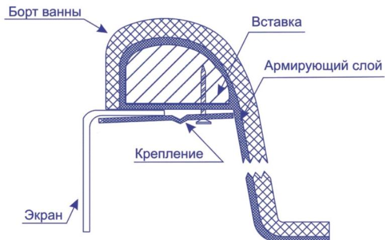
Рисунок 5.3.1 Схема монтажа декоративного экрана
